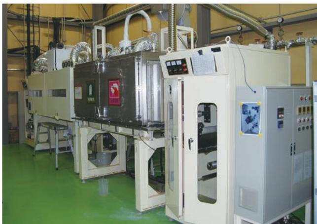
写真7 過熱水蒸気炉を備えた塗工装置
